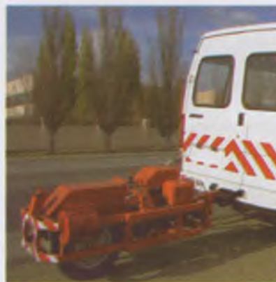
Рис. 12. Система измерения ровности и сцепления динамометрическим прицепом ПКРС-2У
